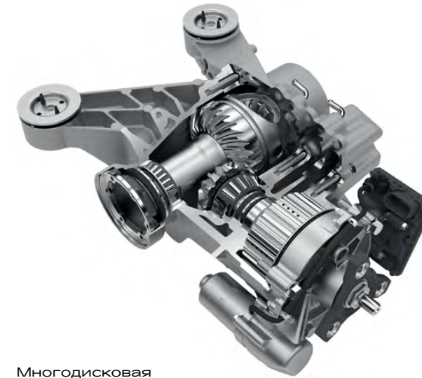
Многодисковая электрогидравлическая муфта полного привода
