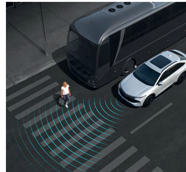
Автоматическая система торможения с функцией распознавания пешеходов
