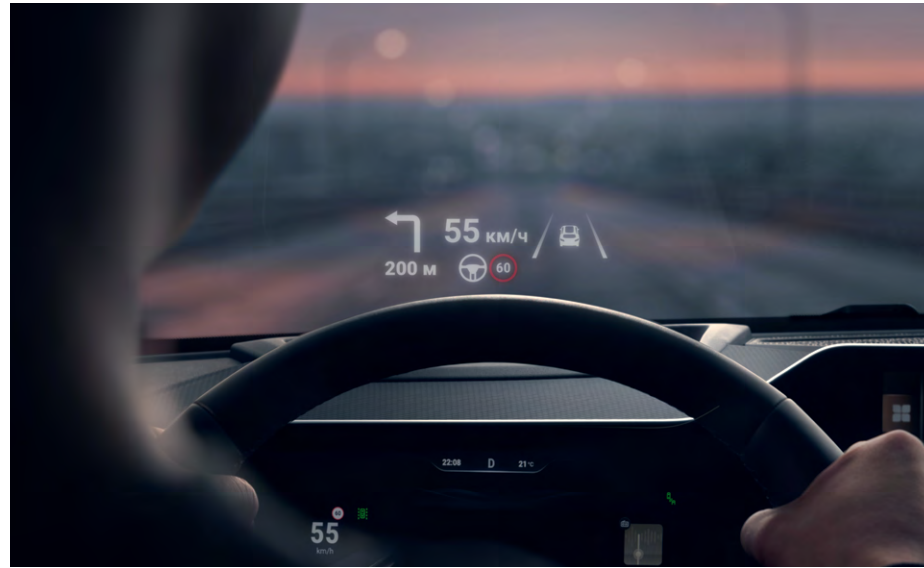
Проекционный дисплей с режимом подсказок навигации
