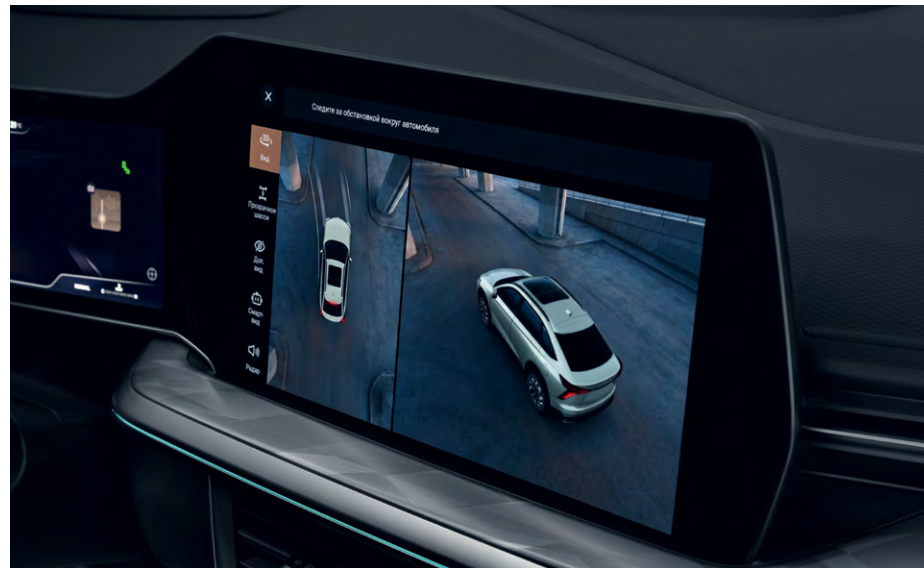
Система камер кругового обзора и функция «Прозрачный капот»
