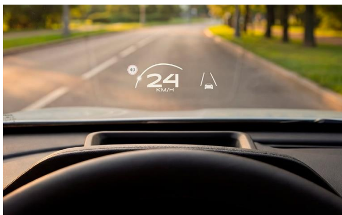
Проекционный дисплей. Выводит данные бортового компьютера на нижнюю часть лобового стекла (для Техно+).
